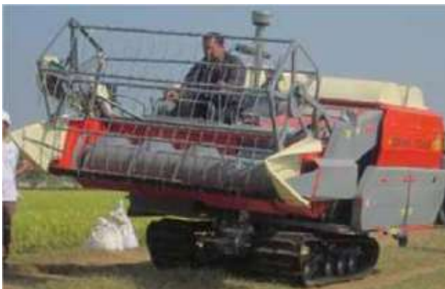
Gambar 3. Mesin panen padi kombinasi ukuran besar
