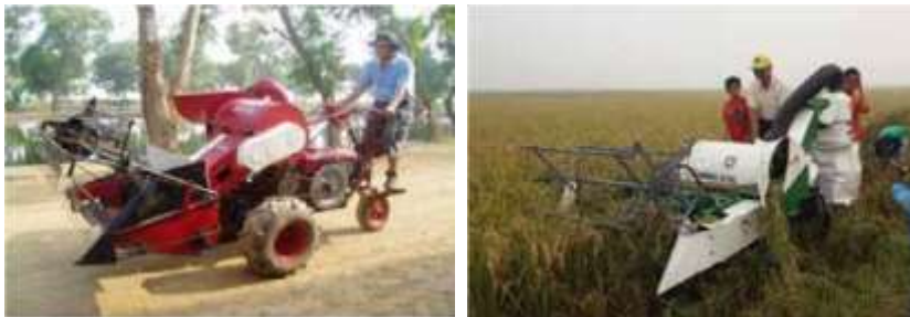
Gambar 1. Mesin panen padi kombinasi ukuran kecil
