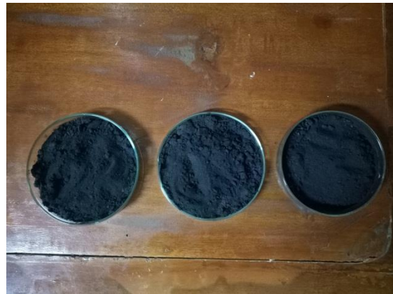
Karbon Aktif Setelah Pengeringan pada suhu 110 °C selama 6 jam
