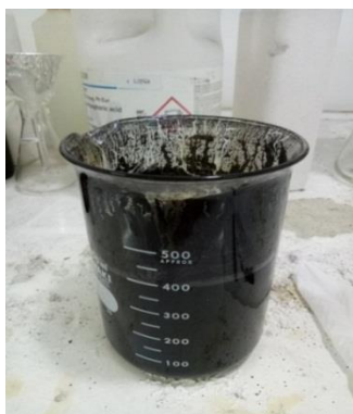
Modifikasi Karbon Aktif Tempurung Kemiri dengan Larutan HNO 3 6 N
