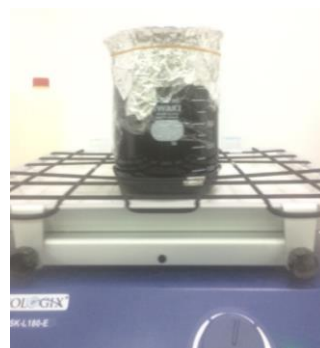
Pengocokan 130 Osilasi Permenit dalam Proses Modifikasi Karbon Aktif Tempurung Kemiri dengan Larutan HNO 3 6 N
