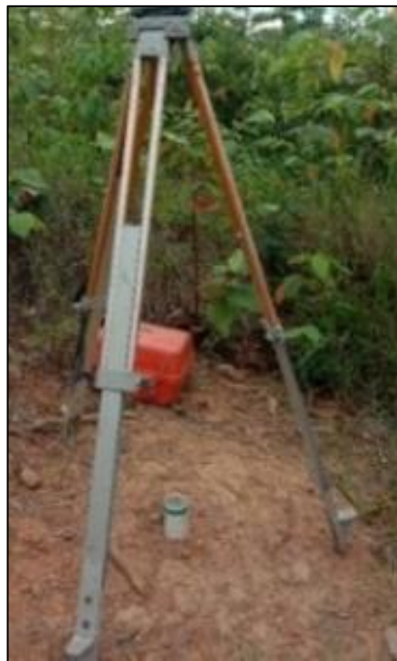
Gambar 2. Tripod sebagai kedudukan total station (Hasvah dan Maiyudi, 2021)
