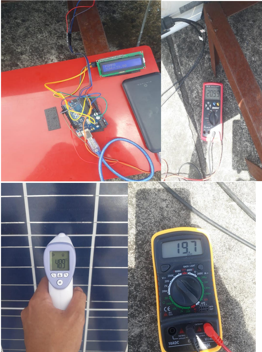
Pengambilan data suhu dan tegangan pada panel surya pada jam 16:00
