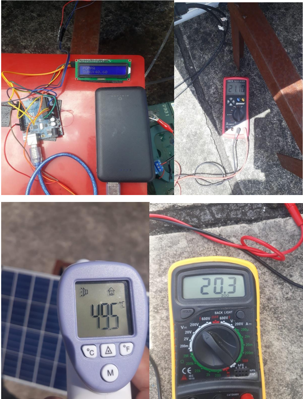
Pengambilan data suhu dan tegangan pada panel surya pada jam 12:00
