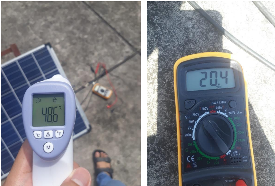
Pengambilan data suhu dan tegangan pada panel surya pada jam 11:00
