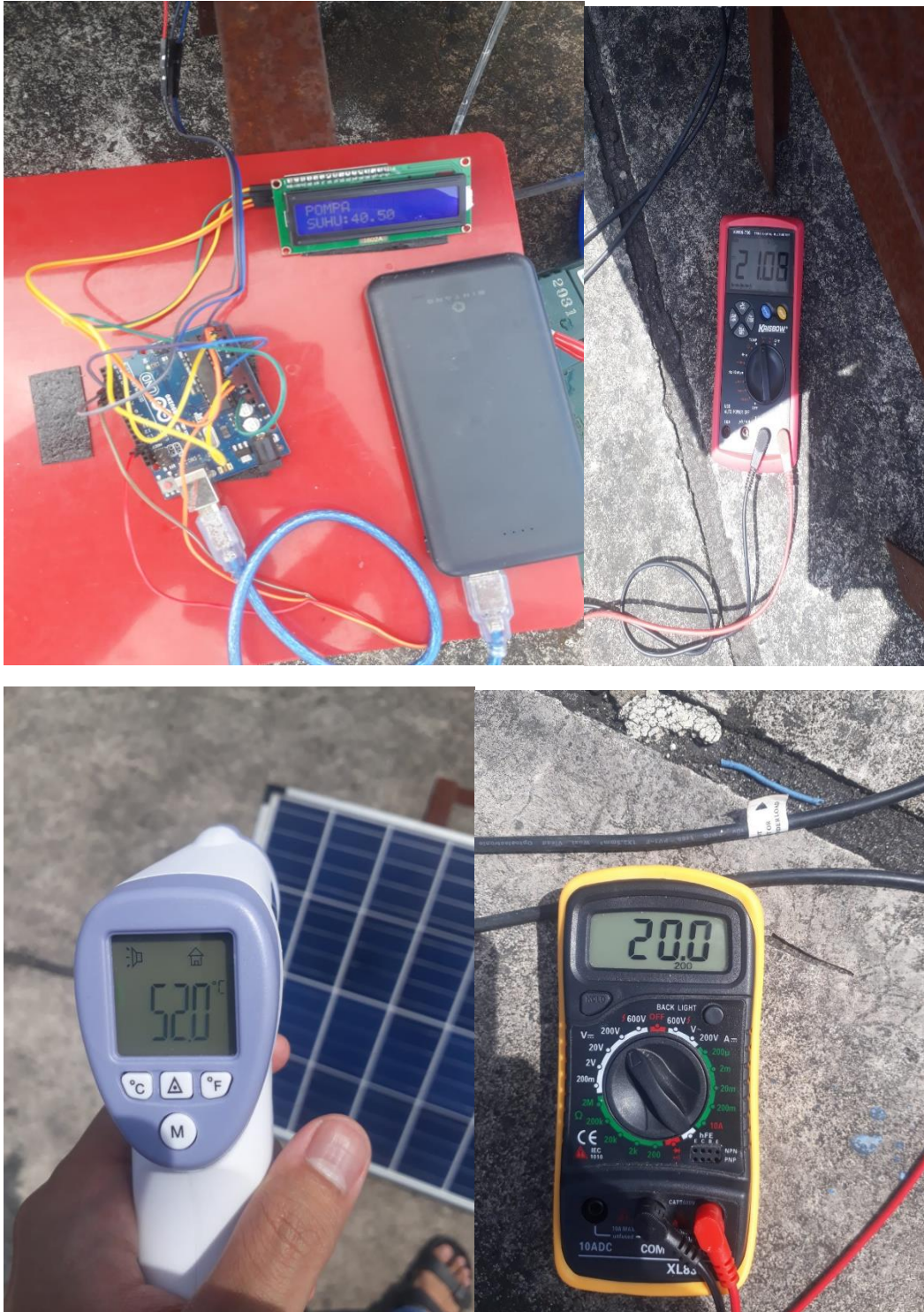
Pengambilan data suhu dan tegangan pada panel surya pada jam 13:00
