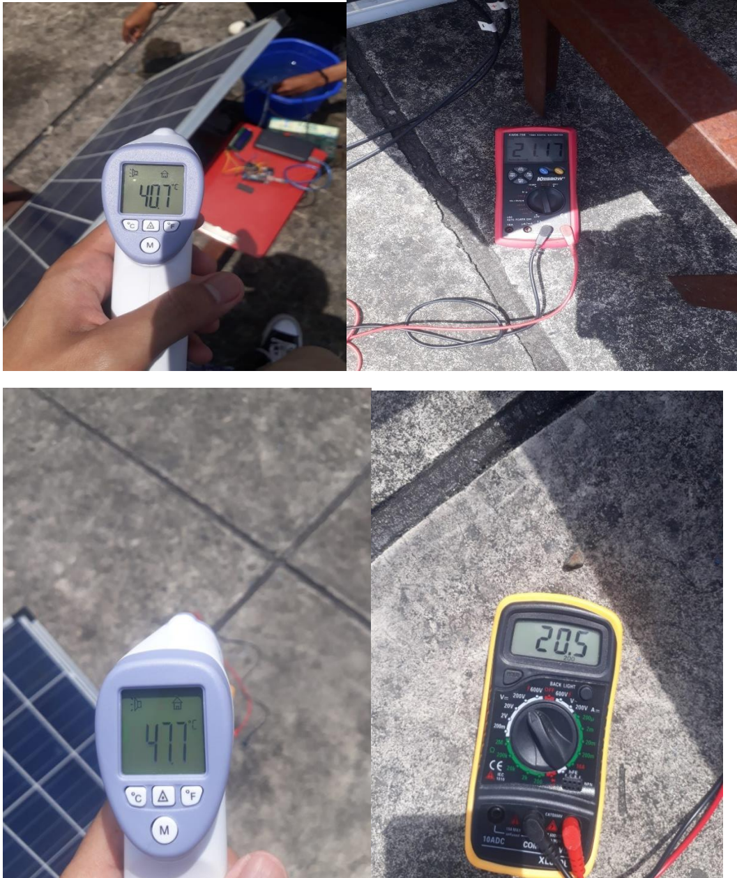
Pengambilan data suhu dan tegangan pada panel surya pada jam 10:00
