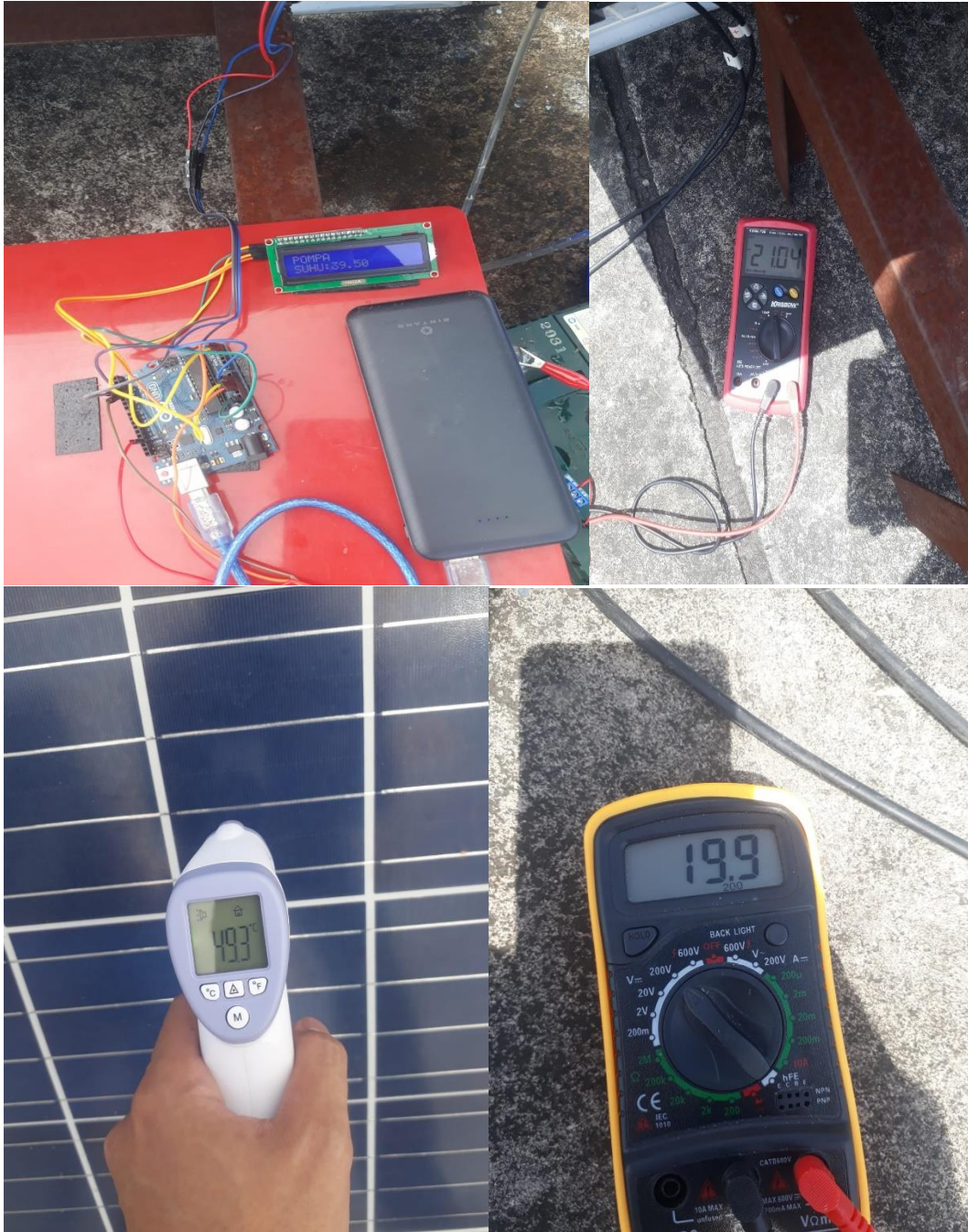
Pengambilan data suhu dan tegangan pada panel surya pada jam 15:00
