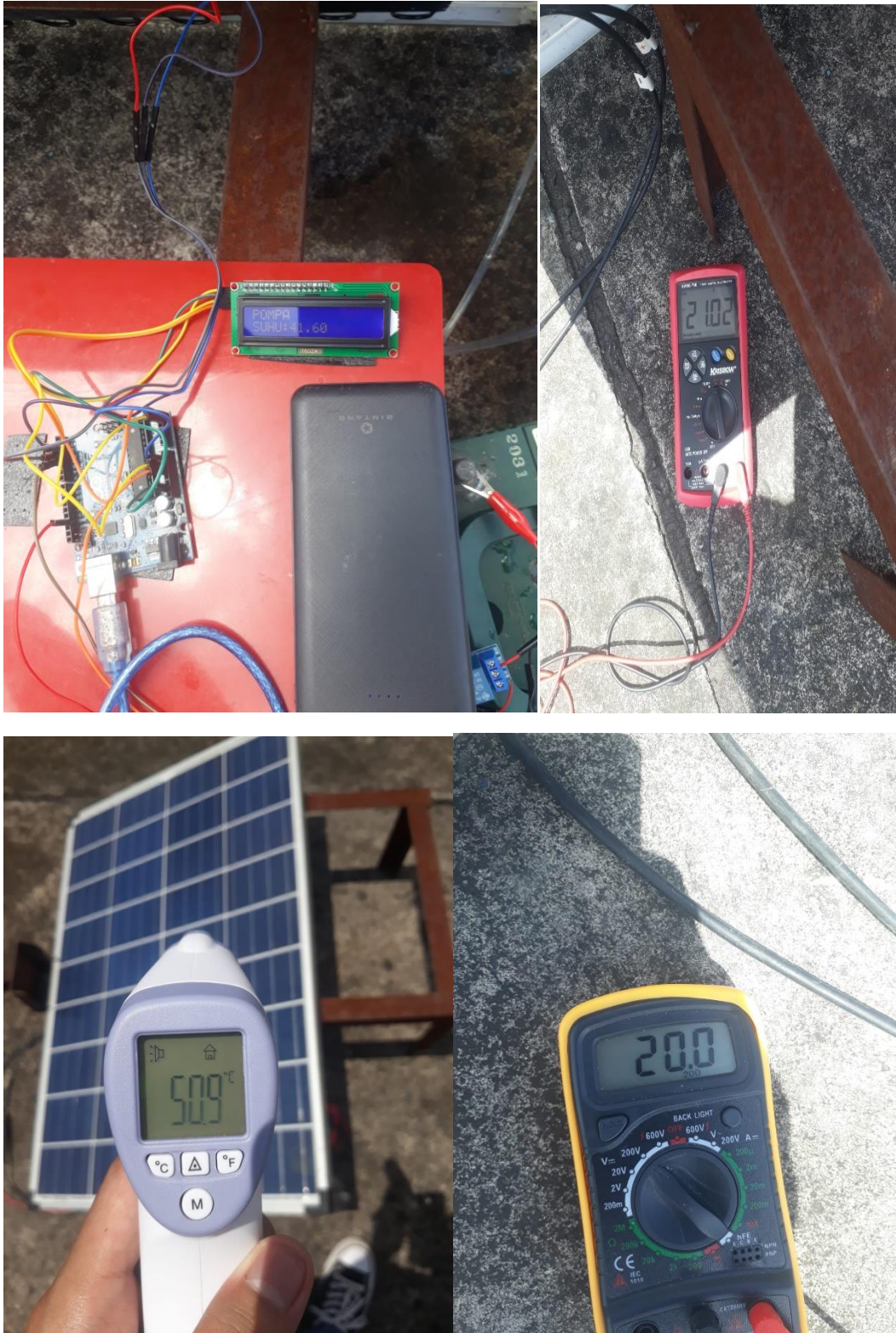
Pengambilan data suhu dan tegangan pada panel surya pada jam 14:00
