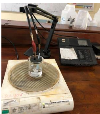
Pengukuran potensial menggunakan potensiometer orion
