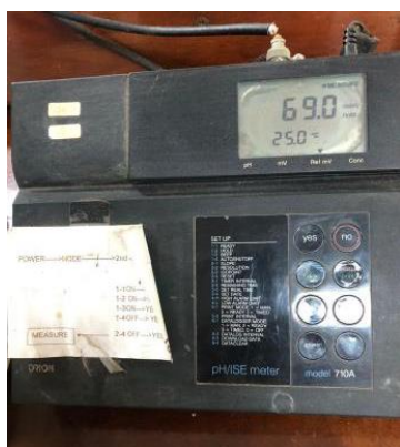
Pengukuran potensial menggunakan potensiometer orion
