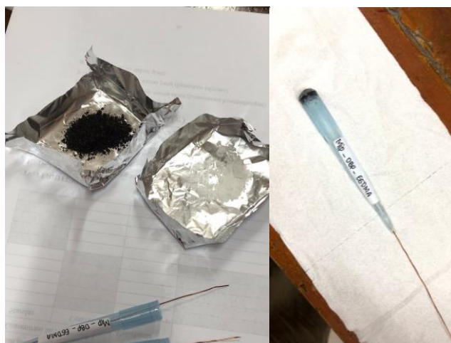
Pembuatan elektroda pasta karbon MIP
