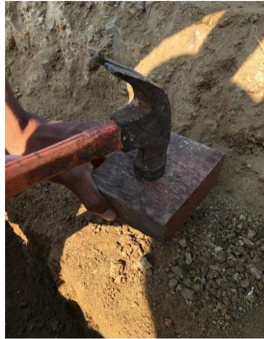
b. Pengambilan sampel tanah tidak terusik
