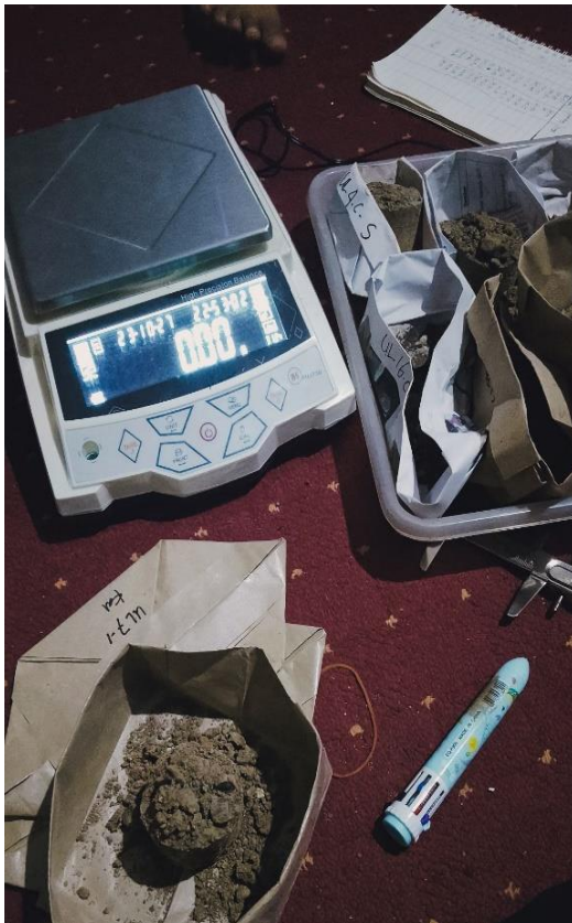
a. Uji Bulk density
