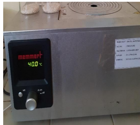
Perendaman Beras dengan menggunakan Water Bath
