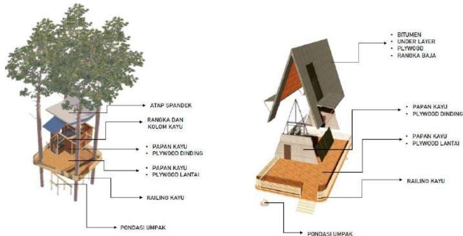
Gambar 2.5 Konsep Sistem Struktur
