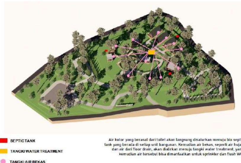
Gambar 2.9 Sistem Air Kotor Bangunan
