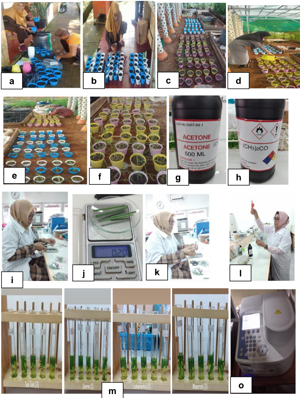
Gambar Lampiran 6. Mekanisme pengujian performa bibit : (a) pengisian pot dengan media tanam, (b) penanaman benih, (c) tata letak benih di screen house, (d) penyiraman (e), pembersihan gulma, (f), tanaman siap panen (g,h) zat pelarut klorofil (i) menggunting bibit (j) menimbang bibit (k) memasukkan bibit dalam tabung reaksi (l), memasukkan zat pelarut klorofil (m) melarutkan klorofil (o), spektrofotometer
