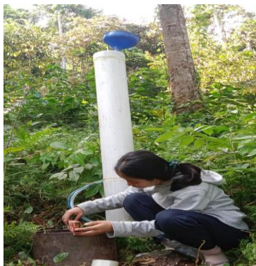
Pemasangan pipa marriot
