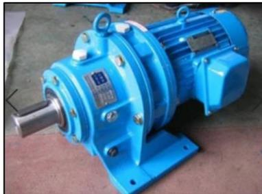
**Gambar 8.** *Gearbox pada sistem conveyor*
