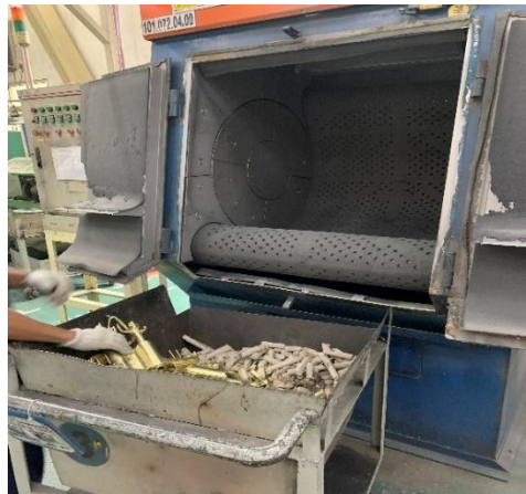
Mesin Shotblast (Elemen kerja 4)
