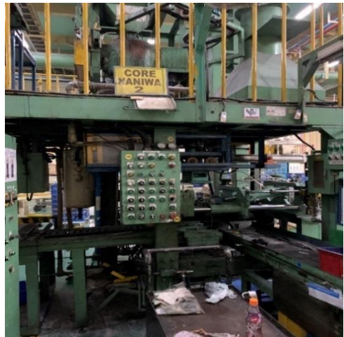
Proses mencetak core (Elemen kerja 1)
