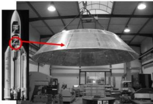
**Gambar 6** Aplikasi Sandwich Aluminium Foam pada roket (*Sumber : Banhart, 2008*)
