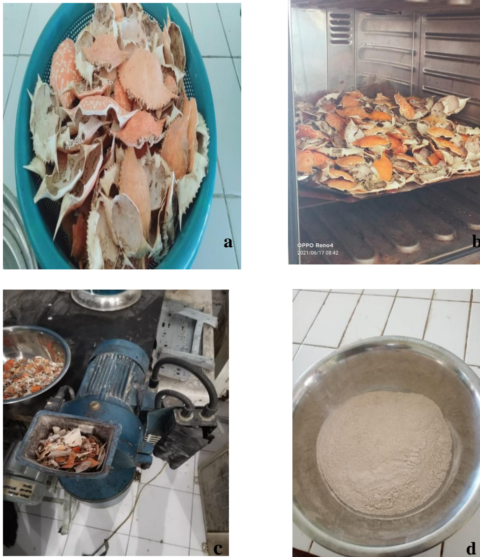
Gambar 10: Proses pembuatan serbuk cangkang kepiting rajungan. a; bahan baku limbah cangkang kepiting rajungan ( Portunus pelagicus ) dibersihkan. b; Cangkang kepiting rajungan dikeringkan dalam oven, c; Cangkang kepiting yang telah kering kemudian digrinder hingga halus, d; Bubuk cangkang kepiting yang telah di grinder kemudian diayak hingga ukuran 100MeSH
