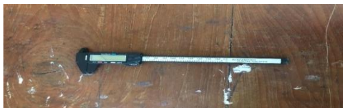
Ket. Jangka sorong (berfungsi untuk mengukur tinggi dan lebar telur, tinggi dan lebar albumen dan tinggi dan lebar yolk)
