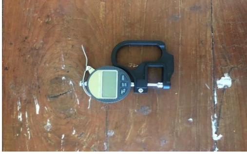
Ket. Mikrometer ( berfungsi untuk mengukur ketebalan kerabang)
