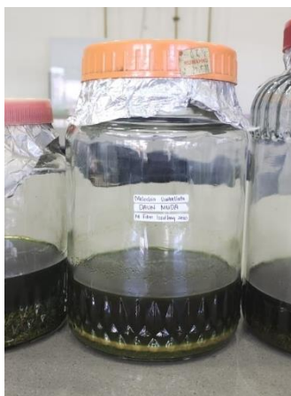
Gambar 7. Ekstraksi dengan metode maserasi
