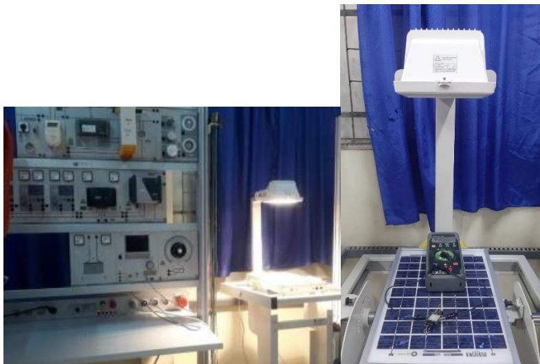
Pengujian arus-tegangan dengan Solar Simulator
