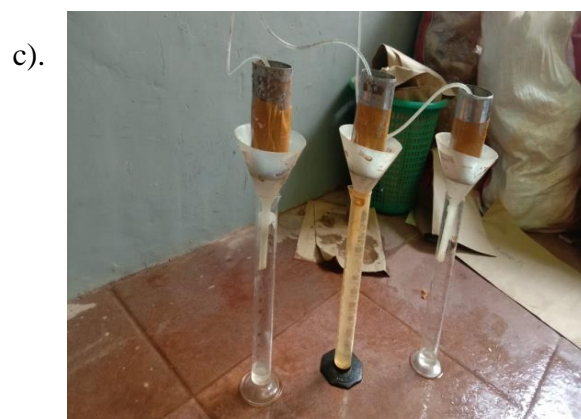
Lampiran 33. Gambar Analisis Laboratorium a). Tekstur Tanah b). C-organik Tanah c). Permeabilitas Tanah
