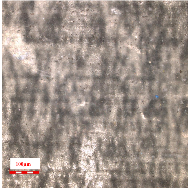
Gambar A.9 Struktur mikro aluminium foil pada tegangan 12 volt dengan konsentrasi 3 molar
