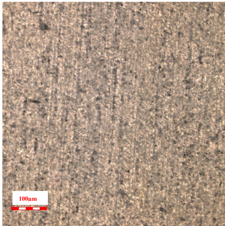
Gambar A.2 Struktur mikro aluminium foil pada tegangan 8 volt dengan konsentrasi 2 molar
