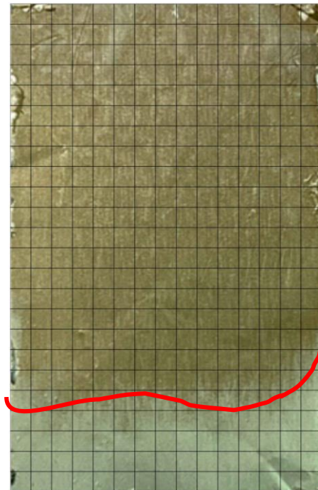
Gambar A.27 Luas Permukaan aluminium foil hasil anodizing pada tegangan 12 volt dengan konsentrasi 3 M
