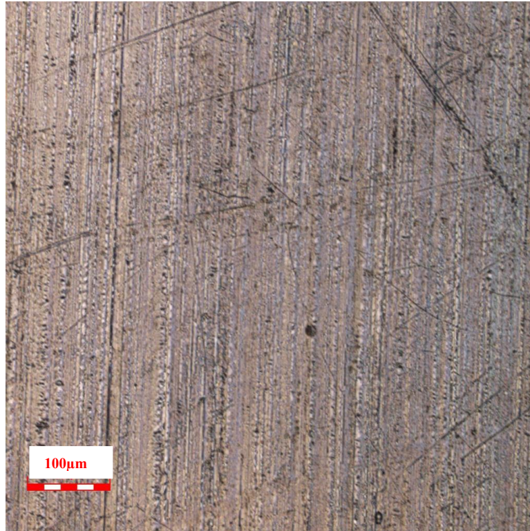
Gambar A.1 Struktur mikro sampel tanpa perlakuan ( non anodizing )
