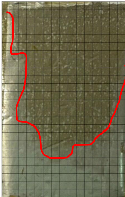
Gambar A.23 Luas Permukaan aluminium foil hasil anodizing pada tegangan 14 volt dengan konsentrasi 2 M
