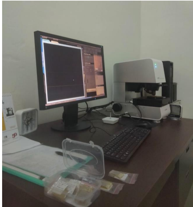
Gambar C.5 Proses pengujian mikrostruktur dan kekasaran permukaan
