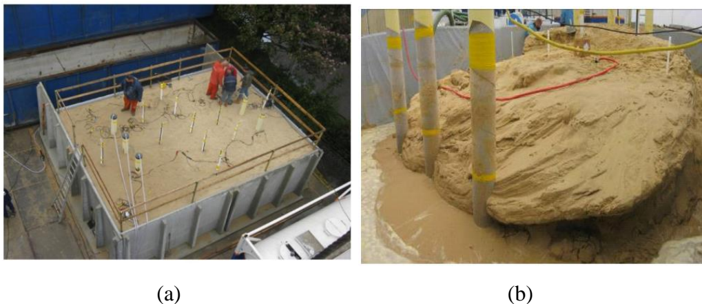
Gambar 6. Biogrouting sementasi(a) pasir sebanyak 100 m 3 dan (b) pasir yang tersementasi sebanyak 43 m 3 (Van Paassen 2011)
