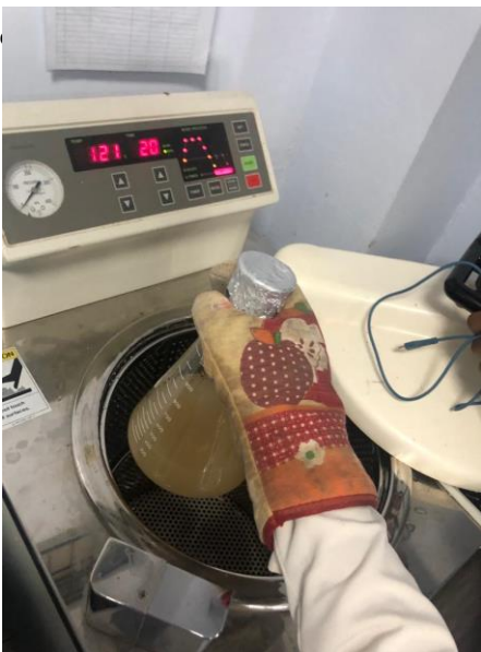
(c) Sterilisasi basah media pikovskaya menggunakan autoclave
