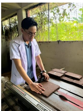
Memotong Papan Partikel yang Telah Dikondisikan
