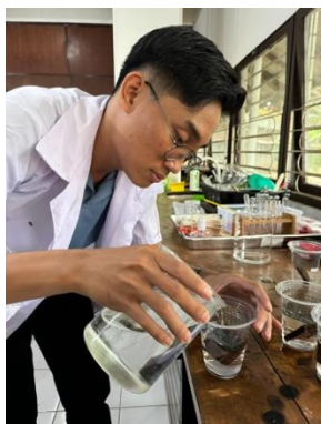
Pengujian Pengembangan Tebal Papan Partikel
