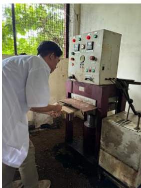
Mengempa Campuran Bahan lalu Melakukan Pengondisian
