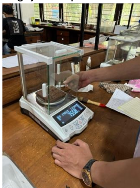
Pengujian Kadar Air dan Kerapatan Papan Partikel
