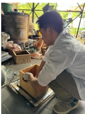
Mencetak Campuran Bahan yang Telah Tercampur Rata
