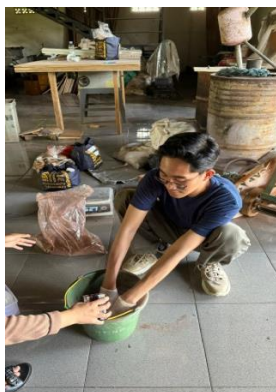
Pencampuran Partikel Kayu dan Perekat TRF Secara Manual
