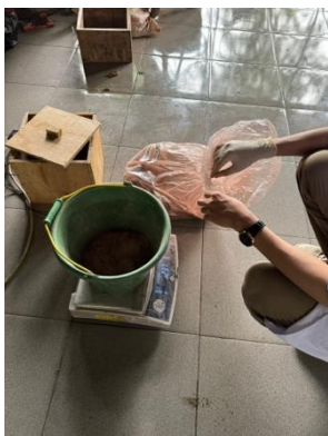
Pencampuran Partikel Kayu dan Perekat TRF Secara Manual
