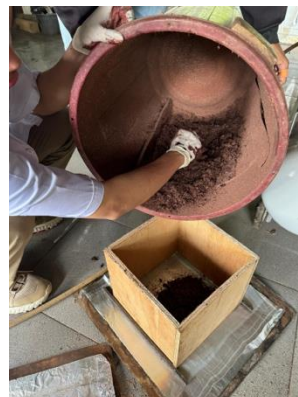
Pencampuran Partikel Kayu dan Perekat TRF Secara Manual
