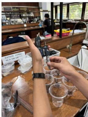
Pengujian Pengembangan Tebal Papan Partikel
