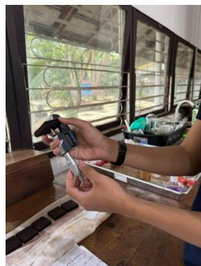
Pengujian Pengembangan Tebal Papan Partikel
