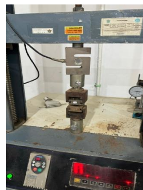
Pengujian Internal Bond (IB) Papan Partikel
