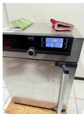
Pengujian Kadar Air dan Kerapatan Papan Partikel
