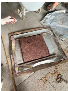
Mencetak Campuran Bahan yang Telah Tercampur Rata
