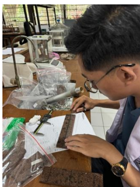
Pengujian Pengembangan Tebal Papan Partikel
