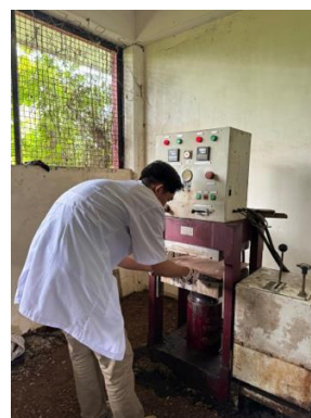
Mencetak Campuran Bahan yang Telah Tercampur Rata
