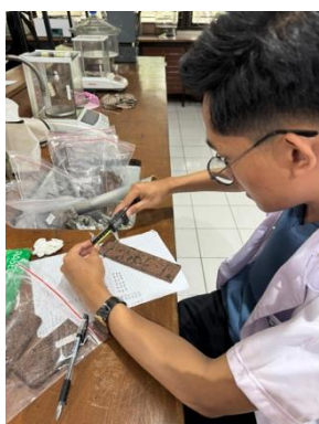
Pengujian MOR dan MOE Papan Partikel
