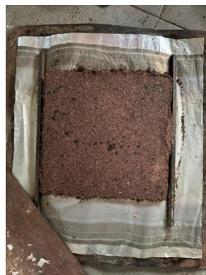
Mengempa Campuran Bahan lalu Melakukan Pengondisian
