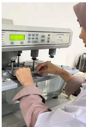
Gambar 11. Pengaturan alat disolusi
