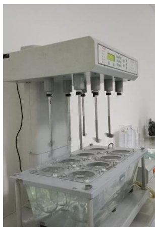
Gambar 10. Alat disolusi tipe II
