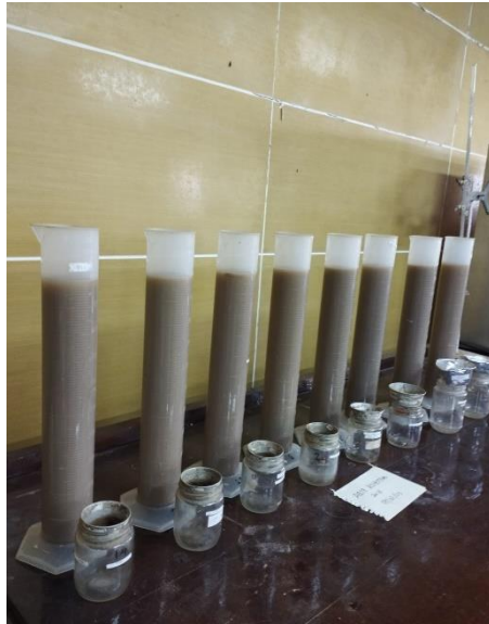
Proses pengukuran tekstur tanah menggunakan metode hidrometer
