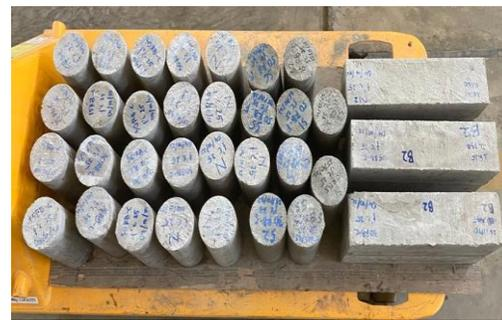
Dilakukan perawatan dengan metode curing air.
