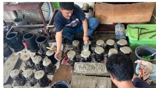
Memadatkan benda uji dengan menggunakan vibrator (alat penggetar).
