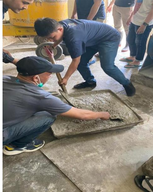
Pengujian slump beton
