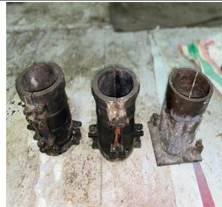
Mencetak beton dengan memasukkan beton kedalam cetakan yang di bagi menjadi 3 lapis dimana setiap lapis di padatkan dengan 7 kali tumbukan. Dan mendiamkan mortar sampai mengeras  $\pm$  24 jam.
