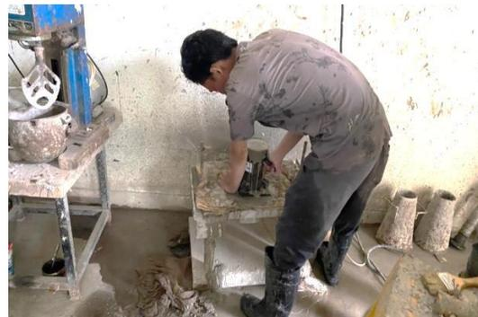
Setelah didiamkan  $\pm$  24 jam. beton dikeluarkan dari cetakan dan
