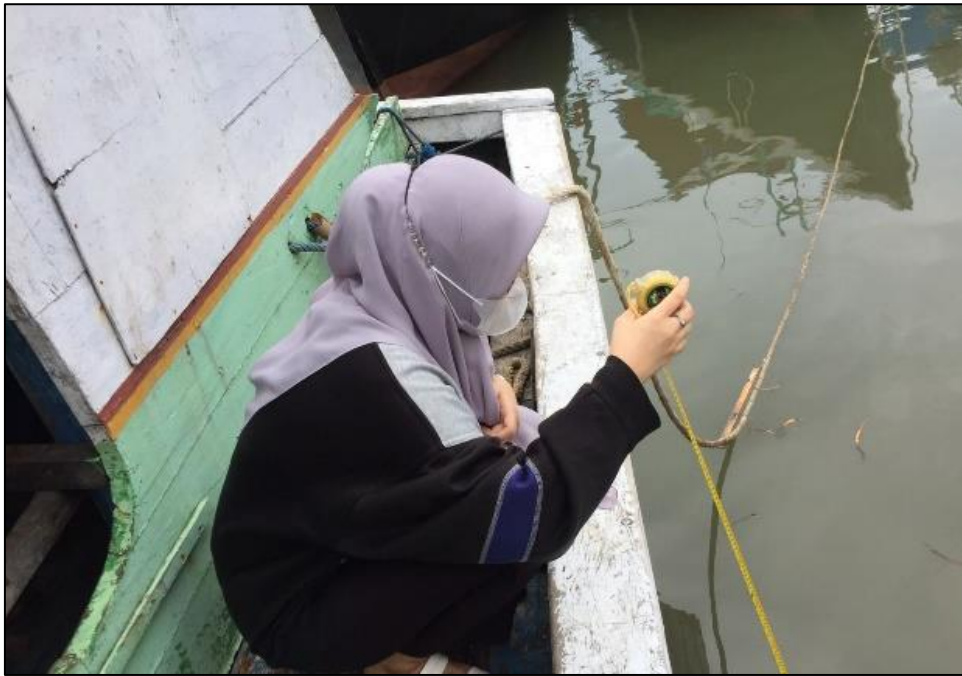
Pengukuran jarak antar kapal dan jarak lunas ke dasar perairan
