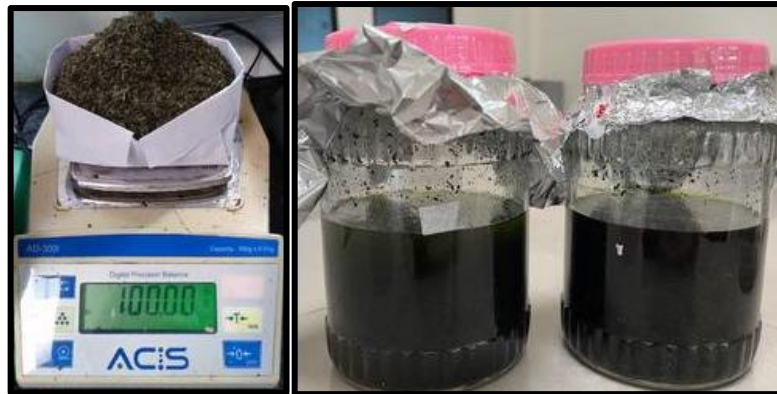
Gambar 14. Proses Penimbangan Simplisia dan Ekstraksi Maserasi
