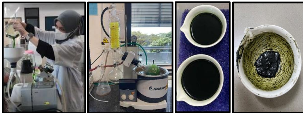
Gambar 15. Proses Penguapan Ekstrak Menggunakan Rotavapor dan Silika Gel
