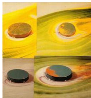
Gambar 2 Percobaan aliran viskositas melalui sebuah pilar berbentuk tabung
