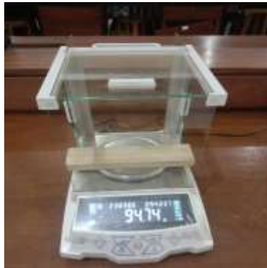
Sampel kayu ditimbang sebelum dan sesudah di oven untuk mengetahui kadar air
