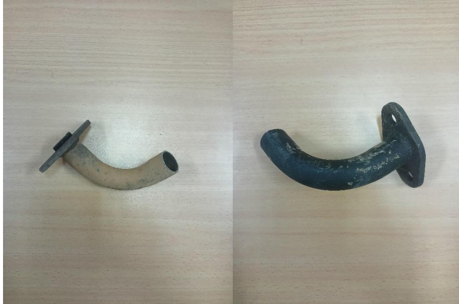
Bagian knalpot sepeda motor A lama (kiri) dan baru (kanan)
