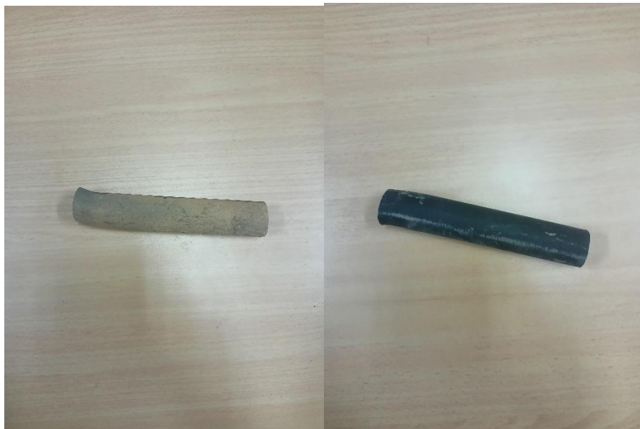
Bagian knalpot sepeda motor B lama (kiri) dan baru (kanan)
