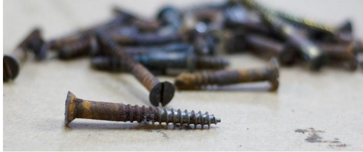
Gambar 2.2 Korosi Celah (Sumber : chemindo.com)
