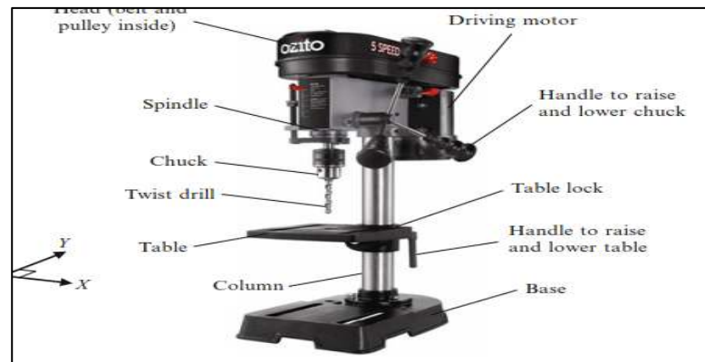
Gambar 2.4 mesin bor tekan lurus
