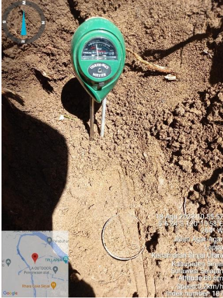
Pengambilan sampel tanah tidak terusik
