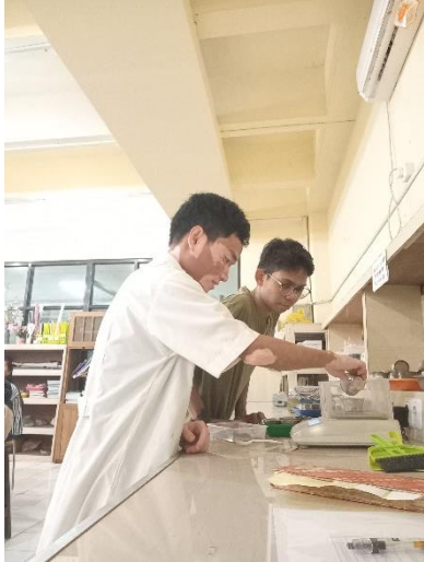
Menimbang sampel tanah yang telah dihaluskan untuk pengujian tekstur tanah
