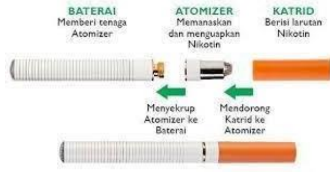
Gambar 1. Struktur Dasar Rokok Elektrik (Sumber: BPOM, 2015)
