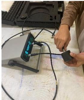
Langkah kedua yaitu mengoles gemuk (gel stempet) pada ujung sampel yang akan diletakkan tranduser, dan mulai pembacaan kecepatan rambat gelombang pada alat, serta mencatat hasil kecepatan rambat gelombang dari alat.
