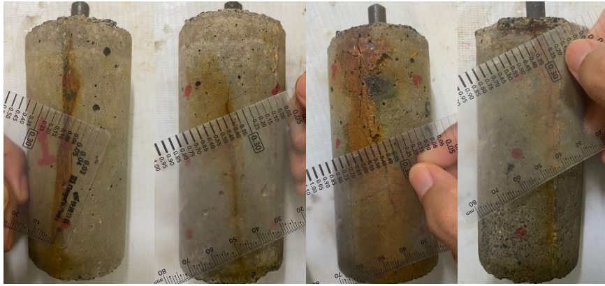
Lampiran 10. Dokumentasi mengukur lebar retak akibat korosi tulangan
