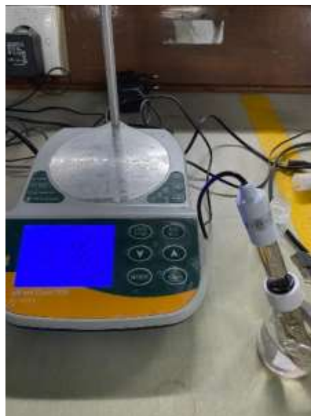
Gambar 15. Uji pH menggunakan pH meter
