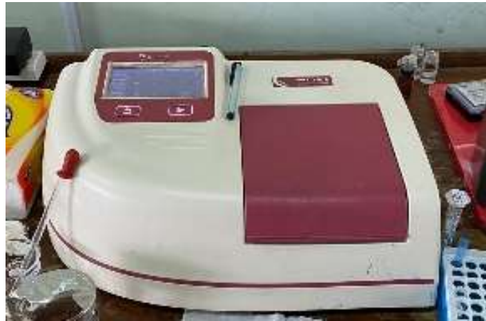
Gambar 16. Pengukuran drug loading menggunakan spektrofotometer UV-Vis
