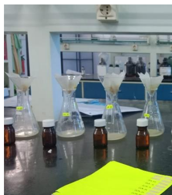
Proses Penyaringan setelah dishaker
