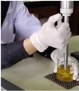
Gambar 9. Proses Formulasi MP-LP Menggunakan Metode Emulsifikasi
