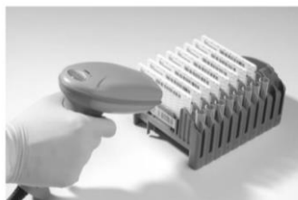
Gambar 8 Kaset Kompak VITEK 2 Berisi 10 Kartu dan Tabung Suspensi dan Pemindai Kode Batang untuk Entri Data. (Pincus, 2010)
