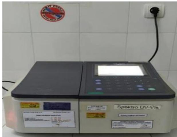
Gambar 10. Alat Spektrofotometri Uv-Vis (Chusna, 2021)
