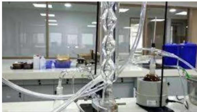
Gambar 7. Alat Refluks (Hati *et al.*, 2023)
