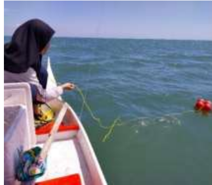
Pengukuran kecepatan arus
