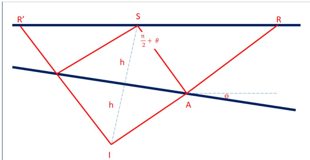
$$\text{Traveltime } t \text{ untuk gelombang refleksi adalah } t = \frac{SA+AR}{v}$$
