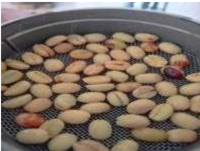
Gambar 28. Proses pengeringan mekanis pengolahan yellow honey .
