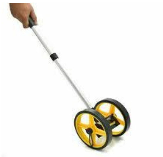
Lampiran 11. Gambar Meteran, Peralatan Yang Digunakan Untuk Mengukur Penggal Pengamatan Pada Saat Penelitian
