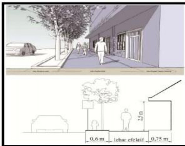
Gambar 15. Teori Jalur Terpusat Sumber : Kementerian Pekerjaan Umum, 2014
