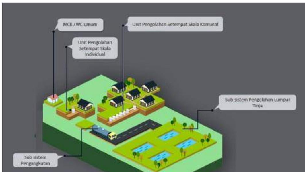
Gambar 2.1. Komponen Sistem Pengolaan Air Limbah Domestik Setempat (SPALD-S)
