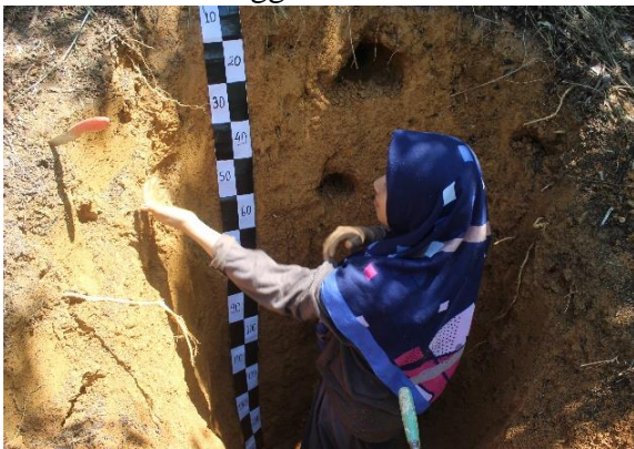
Pengambilan sampel tanah terganggu
