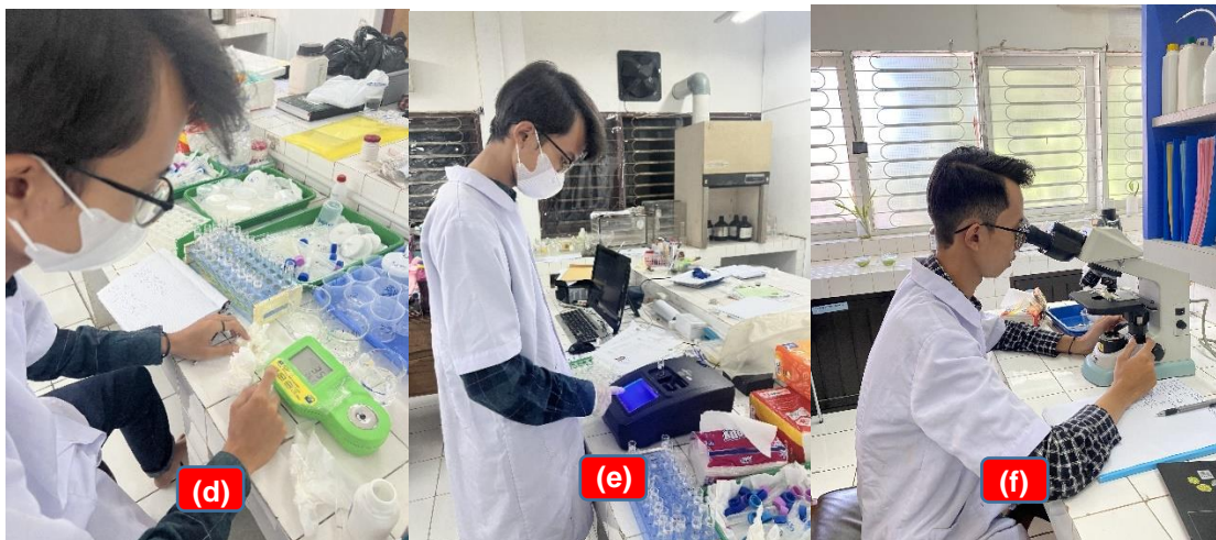
(a) Pengukuran parameter pH dan suhu; (b) pengukuran parameter DO; (c) Pengambilan sampel fitoplankton; (d) pengukuran parameter salinitas; (e) pengukuran parameter nitrat dan fosfat; (f) identifikasi sampel fitoplankton
