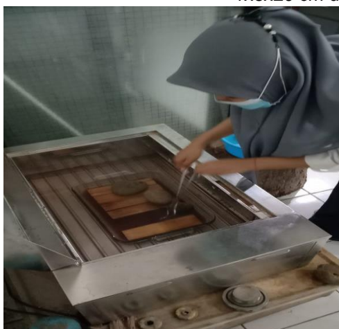
Proses perlakuan awal (perendaman panas dengan suhu 80°C selama 24 jam)
